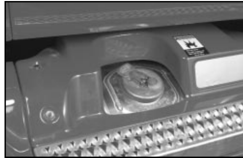
387: fuel tank fill
